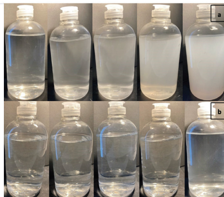
Σύγκριση μεταξύ της θολότητας του νερού με αυξανόμενη σκληρότητα από 20° fr σε 100° fr σε pH=10,5 με απουσία Magic Drop (a) και με την παρουσία Magic Drop (b).
